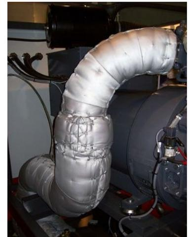
Ein netter Nebeneffekt der Dämmmatratzen ist die zusätzliche Lärmverringering. Durch die textile Oberfläche der Isolierung schird Schall absorbiert. Bei einer klassischen Blechisolierung wird der Schall hingegen reflektiert.
